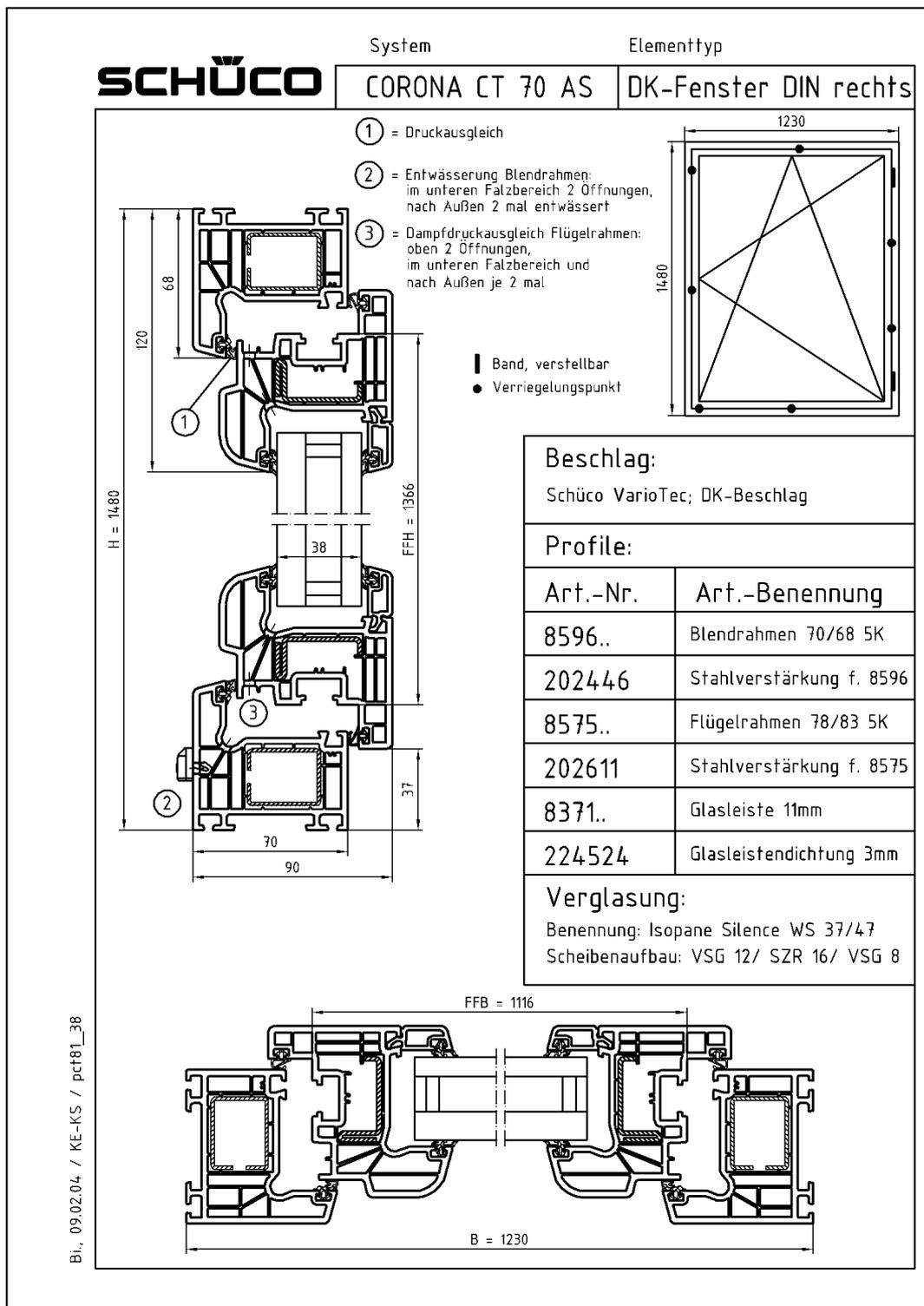
**Bild 1** Schnittzeichnungen des Probekörpers
